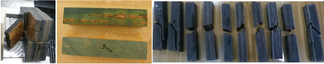
Rys. 5. Próbkę po badaniu mrozoodporności; a) odspojenia po płaszczyźnie laminacji łupka Markapur Slates, b) rdzawe wykwity oraz spękania na próbkach łupka Jacka Slates, c) rozwarstwienia i niesymetryczne pęknięcia belek po badaniu wytrzymałości na zginanie Markapur Slates
