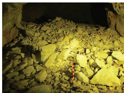
Rys. 5. Kolejność prowadzonych prac: a) wyznaczenie otworów strzałowych w przodku, b) wiercenie otworów strzałowych, c) widok na przodek po robotach strzałowych, d) przykładowy urobek
