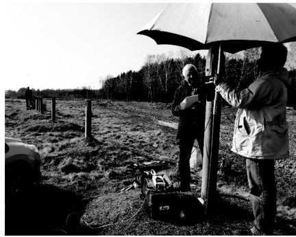
Fig. 4. Tracker Leica AT401 measurements at geodetic base Javoriv Fig. 4. Pomiary analizatorem Leica AT401 w bazie geodezyjnej Javoriv
