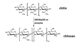
Fig. 1. Chitosan preparation Rys. 1. Przygotowanie chitozanu
