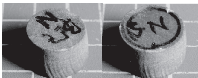
Fig. 2. Column cut without AWJ head tilting (left) and with tilting (right) Rys. 2. Cięcie kolumny bez przechylania głowicy AWJ (po lewej) i przechyleniu (po prawej)
