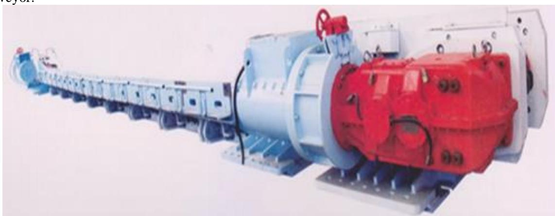
**Fig. 3.** Armored face conveyor SGZ 630/2\*90.
