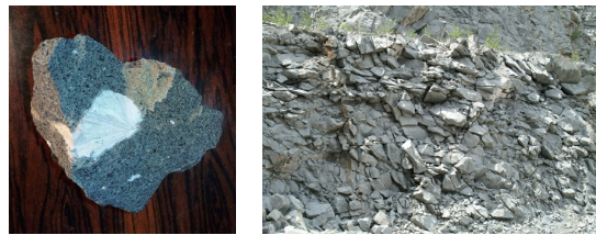
Fig. 9. Natrolitic trachyte, mined by the quarry in Mariánská skála; fracturing of the rock as a result of stress relief during the outcrop of the massif (laccolith) during Saxon tectogenesis Rys. 9. Trachit natrolitowy, wydobywany w kamieniołomie w Mariańskiej Skale; pęknięcie skały w wyniku odprężenia podczas wychodni masywu (lakkolitu) w okresie tektogenezy saksońskiej
