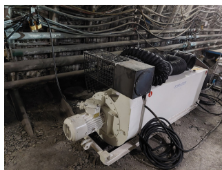
Rys. 5. Odpylacz suchy podczas badań w LW „Bogdanka”
